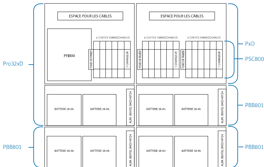
Système modulaire composé d'une centrale Pro32xD, d'une armoire PxD, d'un fond de panier PSC800 supplémentaire et de 3 boîtiers PBB801 supplémentaires
